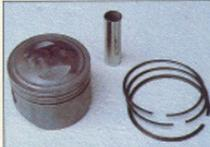
Mahle-Kolben mit 74 mm Ø
