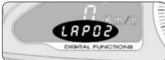
► Durch weitere Betätigung des Lichthupenschalters werden nach und nach alle folgenden Rundenzeiten angezeigt. Wird nach Anzeige der letzten Rundenzeit erneut der Lichthupenschalter betätigt, wird erneut die erste Rundenzeit ("LAP 01") angezeigt.
