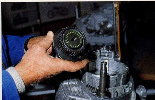
▲ Der Kupplungsträger (hier noch am Abdrück-Werkzeug) und die 25 mit Fett in Position gehaltenen Kugeln mit 3/16 Zoll Durchmesser
