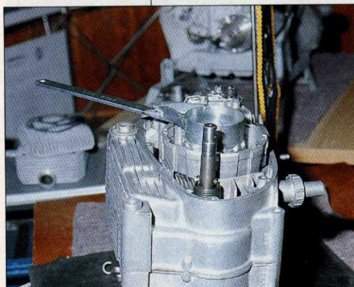
▲ Das selbstgemachte Spezialwerkzeug für Demontage (und auch Montage) des Kupplungsträgers
