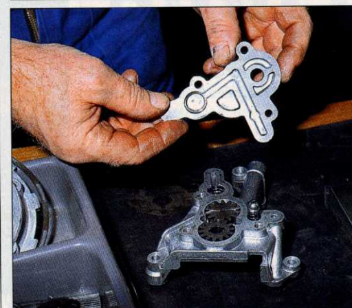
▲ Antriebsrad für den Primärtrieb, Zwischenrad und Antriebsrad für Nockenwelle und Ölpumpe, die als Einheit abgenommen und nur im Zweifelsfall auseinandergenommen wird
