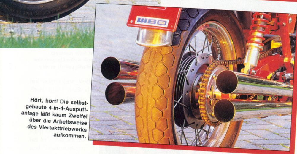
Hört, hört! Die selbstgebaute 4-in-4-Auspuffanlage läßt kaum Zweifel über die Arbeitsweise des Viertakttriebwerks aufkommen.
