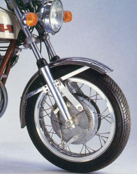
*Le magnifique frein avant double-tambour double-came remplace avantageusement le double-disque à commande mécanique de la 600, mais il s'avère délicat à régler.*
