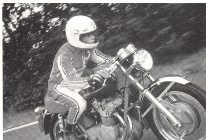
Le frein avant de la 750 S est un double tambour double-came, plus efficace que le double disque mécanique de la 600.
