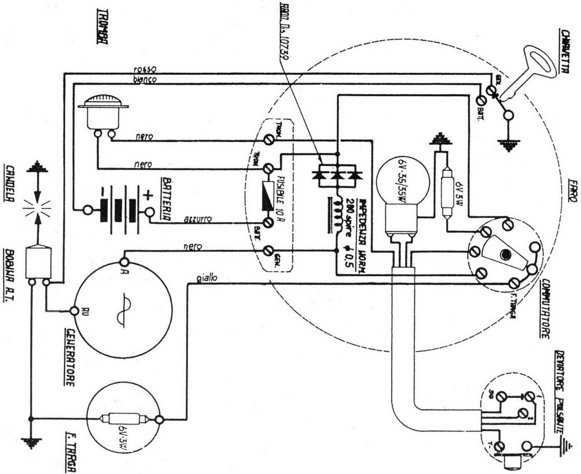
Fig. 6 - Schema impianto elettrico.
